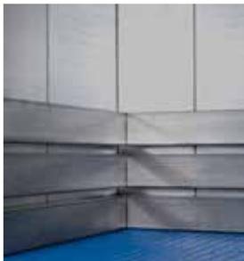
Lisses de protections renforcées, faciles à remplacer, afin d'amortir les chocs inévitables lors du chargement.
