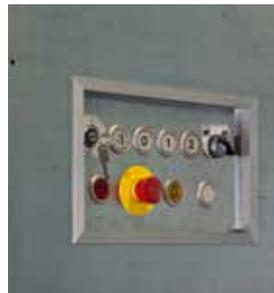
Commande à pression maintenue en cabine, encastrée et protégée par un encadrement afin d'éviter de l'endommager lors du chargement.
