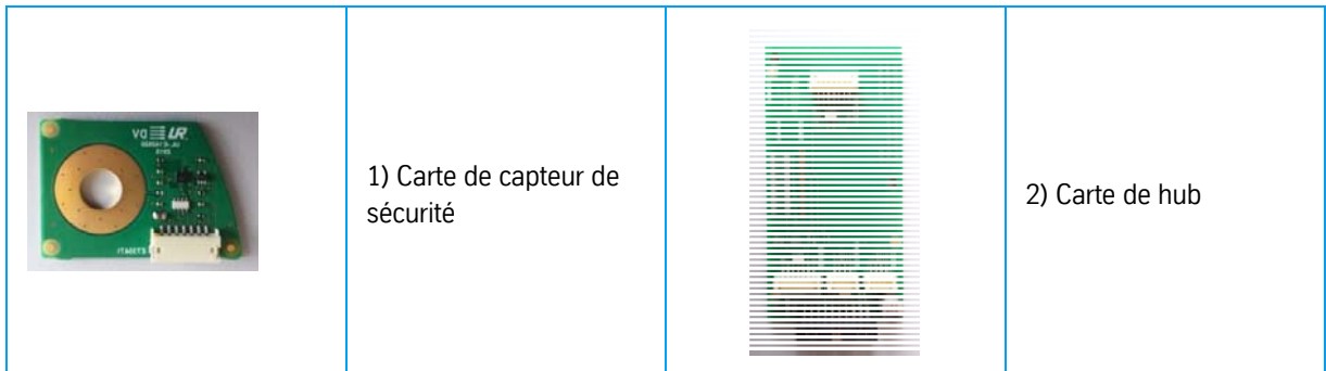
Figure 4-3: Carte de capteur de sécurité et carte de hub dans le socle
