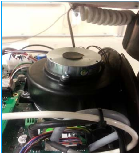
Figure 4-8: Moteur d'entraînement et frein dans l'unité d'entraînement
