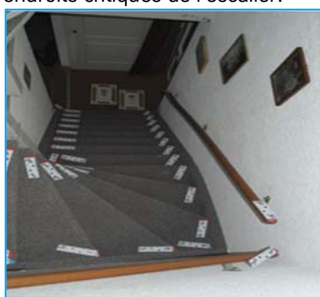
Figure 2-2: Mesure optique des dimensions de l'escalier avec des marqueurs photographiques.
