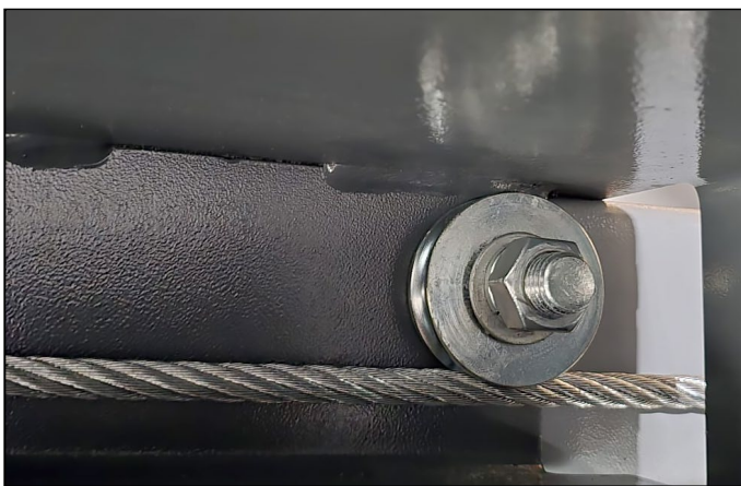
Figure : Poulie de renvoi sous la voie centrale
